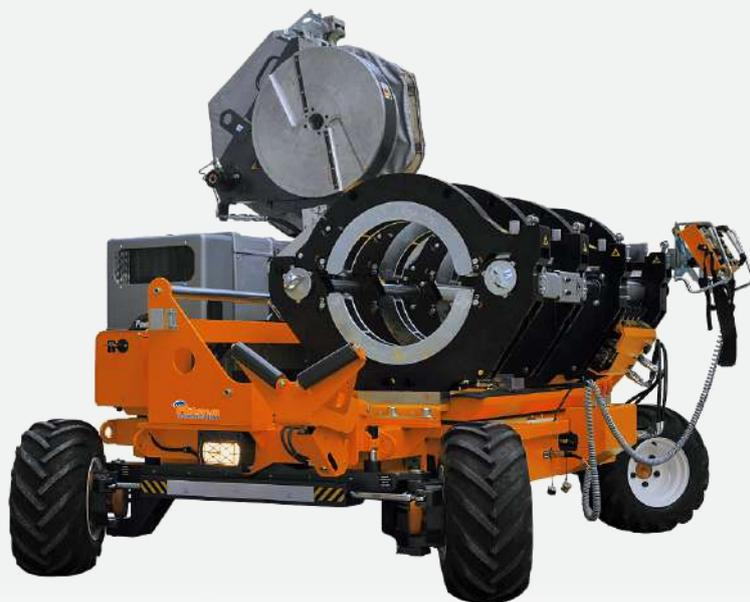
DELTA 630 All Terrain se utiliza en la fabricación de conductos para agua, gas y otros fluidos de hasta Ø630 mm (24" DIPS). La soldadura cumple con los estándares de las normas ISO 21307 y ASTM F2620. Este equipo suelda **tuberías y accesorios**, como: "Y", "T" y cuellos porta bridas. Incluye reducciones de: 280; 315; 355; 400, 450 y 500 mm.
