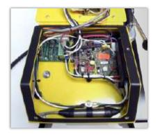
Switch automático de seguridad apaga el equipo cuando la caja de control está abierta.
