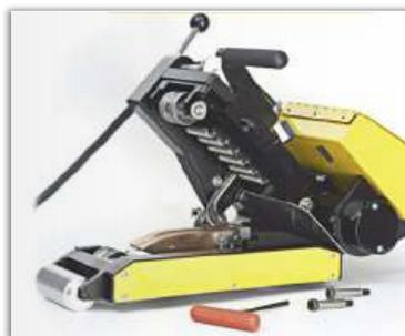
El ensamblaje de la Cuña puede ser removido en 30 segundos, simplemente desconectando el calentador externo y del enchufe de la termocupla.
